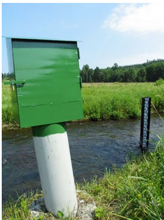
Ryc. 2. Posterunek wodowskazowy na Czarnej Hańczy. Na pierwszym planie budka z limnigrafem, w głębi łąta wodowskazowa (Mackiewicz 2010)
